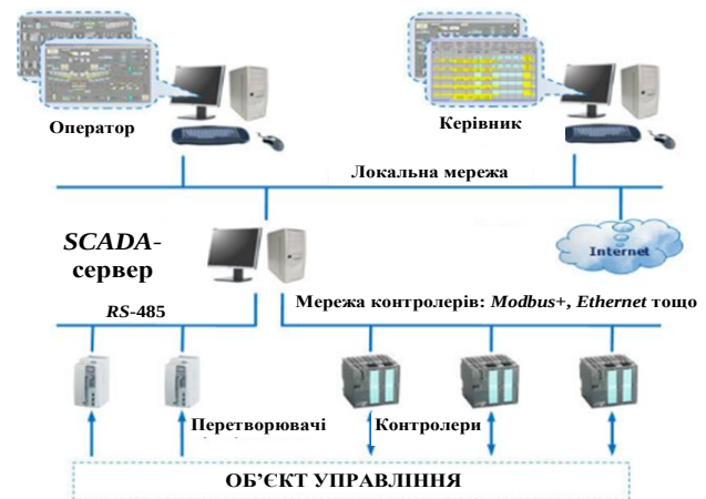
Рис. 2. Структура АСУ ТП
