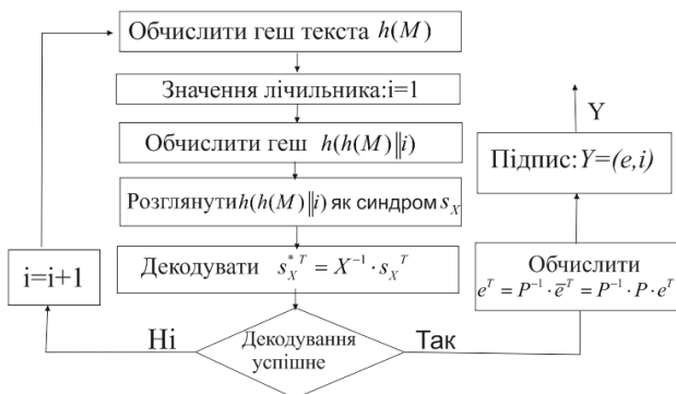
Рис.1 - Процес формування підпису згідно схеми CFS
