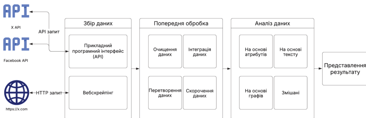
Рис. 1. Загальна архітектура систем виявлення автоматизованих акаунтів у соціальних мережах
