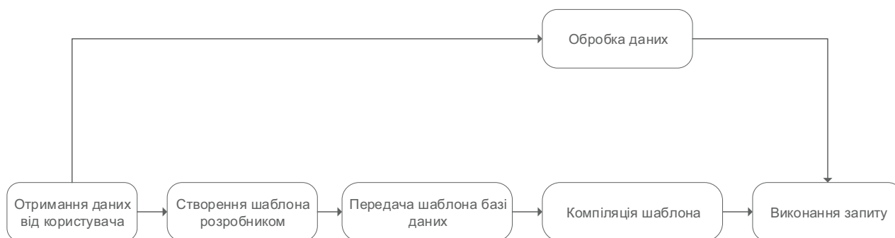
Рис. 8. Процес формування і компілювання шаблону з передачею у нього даних
